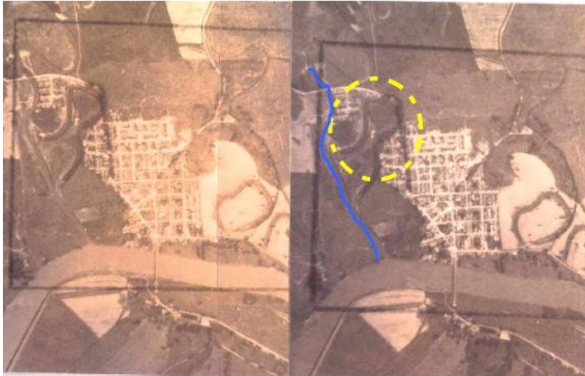
Estereograma del año 1966. Observe el cambio del cauce actual del Río Risaralda luego de ser cortado el meandro "madre vieja" (línea azul, cauce actual, encerrado en amarillo meandro intervenido)
